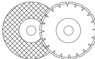
При транспортировке машины всегда снимайте режущий диск.
