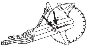
Открутите затем гайки и снимите передний колпак ремня.
