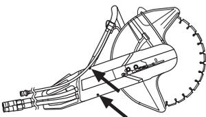
Снимите старый ремень и наденьте новый ремень. Смонтируйте вместе режущий рычаг с частью двигателя и натяните ремень регулировочным винтом. Новый приводной ремень должен быть затем опять подтянут через 30 минут работы.
