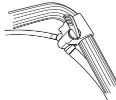
Чтобы закрыть воду, поверните кран в закрытое положение.
