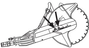
Навинтите затем регулировочный винт так, чтобы четырехгранная гайка находилась посередине отметки на колпаке. Натяжение ремня будет тогда автоматически правильным.
