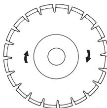
Всегда пользуйтесь только заточенным режущим алмазным диском. Чтобы заточить алмазный диск, разрежьте мягкий материал, например песчаник или кирпич.
