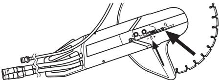
Затяните обе гайки, которыми закреплен режущий рычаг.
