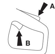
Фиксатор пускателя остается в прижатом внутрь положении до тех пор пока пускатель находится в прижатом внутрь положении. При отпускании ручки, пускатель и фиксатор пускателя возвращаются в свои исходные положения. Это осуществляется при помощи двух независимых одна от другой пружинных возвратных систем. В таком положении станок останавливается и пускатель замыкается.
